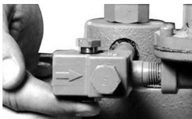
图13. 推动槽阀与固定器一起向上
