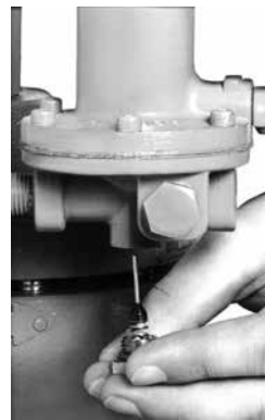
图11. 161EB系列指挥器阀内件拆除/安装
